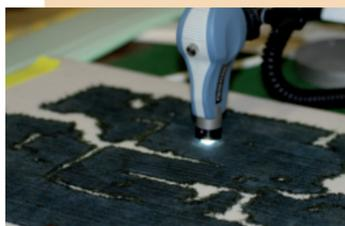
Abb. 3: Untersuchung eines Textils mittels Auflichtmikroskop (400-fache Vergrößerung).
